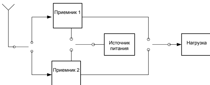
Рис. 2.3. Пример использования ненагруженного резерва замещением
