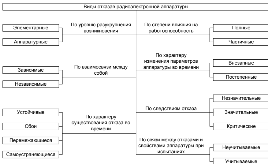
Рис. 2.1. Классификация видов отказов радиоэлектронной аппаратуры
