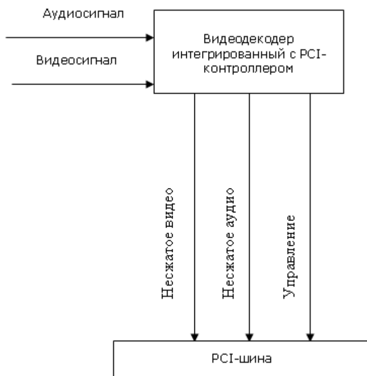
Рис. 9. Структурная схема плат с программным сжатием
