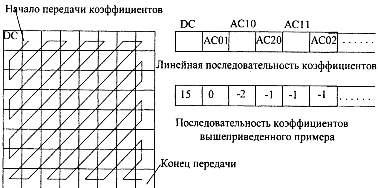
Рис. 4. Формирование линейной последовательности коэффициентов DCT
